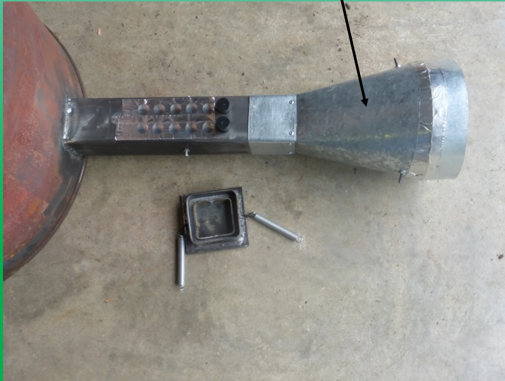
Sheet metal plenum
